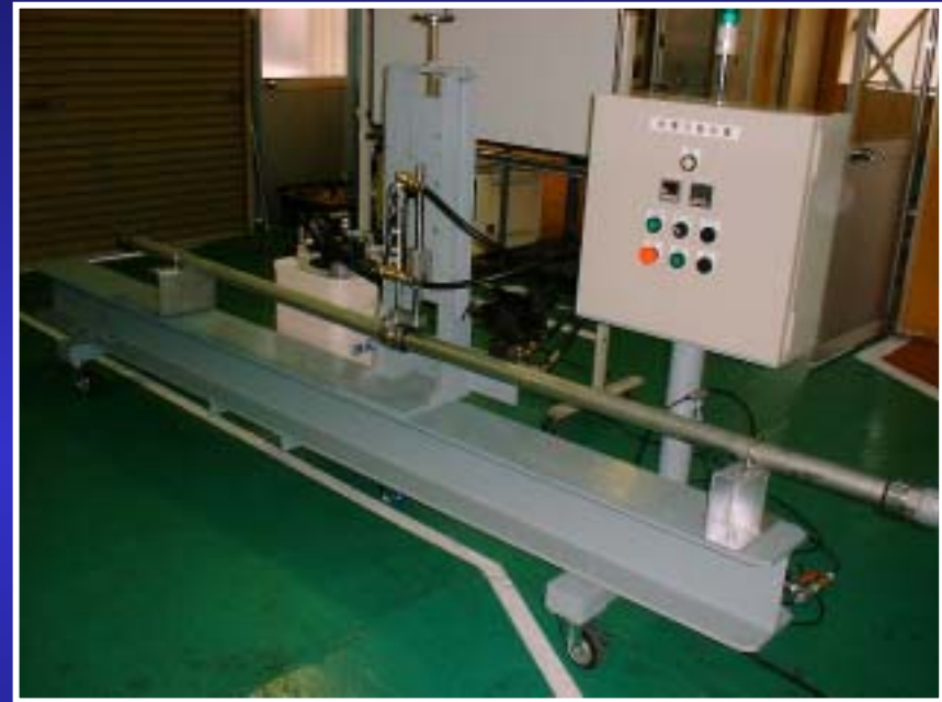
両固定振り試験 試験の層間変位 (5/100)
