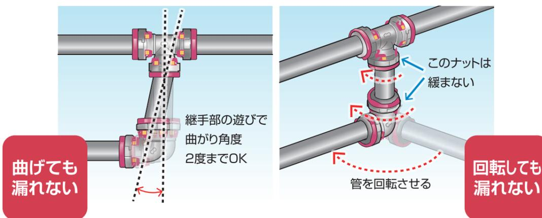
※水圧が加わると、配管のぐらつきは抑制されますが、1口で約0.3mmくらい伸びが生じます。
