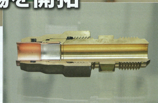
「れいわおっぞん」の構造。レンチで締め込むと銅管に継手の爪が食い込んで抜けなくなる。ゴムシール、メタルシールも施されている
