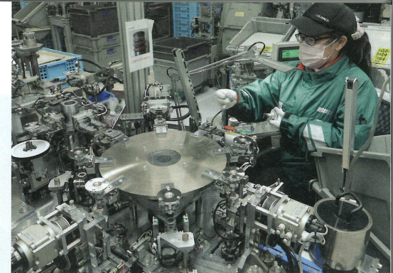
小ロット多品種生産を可能とした多工程集約型ロータリー組立機を自社開発。生産性は従来比2倍という
