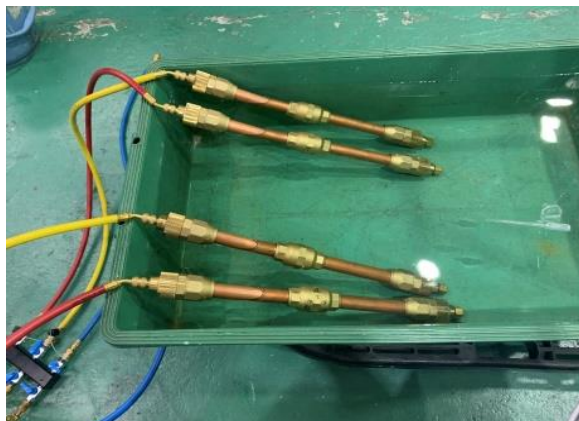
写真9.2－引張試験後の供試体
