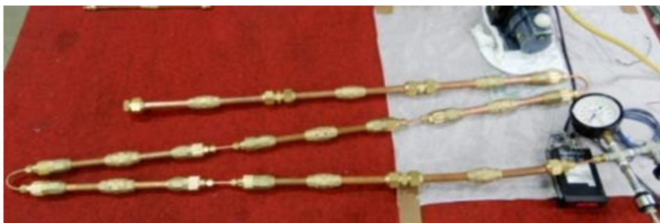
写真7ー 真空試験後の供試体
