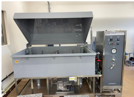
写真12.1—塩水噴霧試験機と供試体
