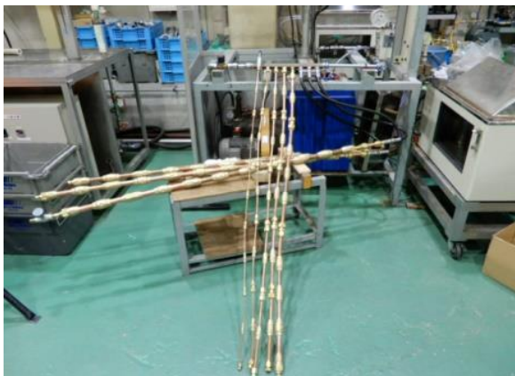
写真8ー疲労試験後の供試体
