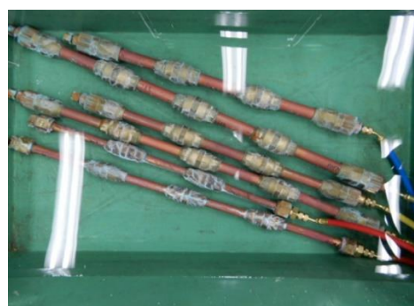
写真12.2—塩水噴霧試験後の供試体
