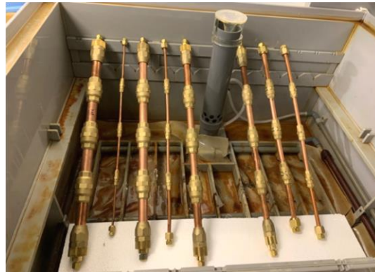
写真12.1—塩水噴霧試験機と供試体
